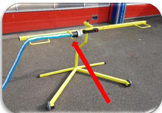
Plaats de storz koppeling tussen de centreerpennen, en begeleidt de slang over de "korte kant".
