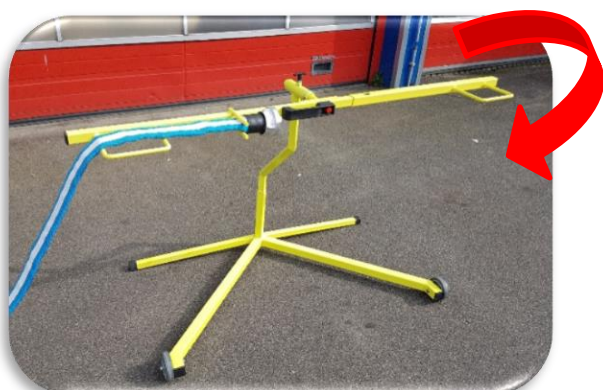
Draai het slangbundelapparaat handmatig.
