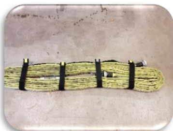
Geloste bundelbandjes, trek de Storz koppeling door naar andere zijde.
