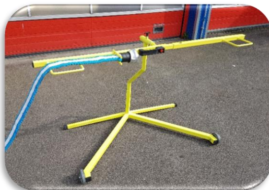
Slangenbundelapparaat geborgd in montagesteun, en gereed voor gebruik.
