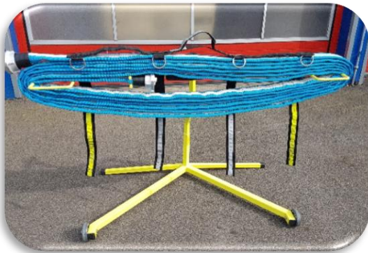
Plaats de bundelbandjes tussen de slang en het bundelapparaat.
