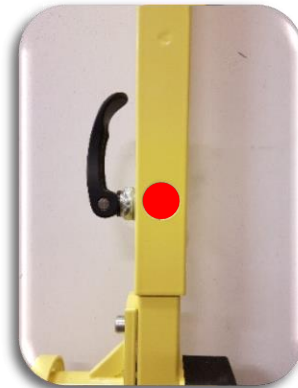
Controlegat volledig rood gekleurd en gesloten snelspanner, u kunt nu de slang afnemen
