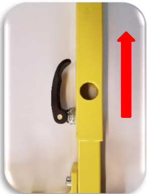
Gesloten snelspanner, weer klaar voor gebruik.
