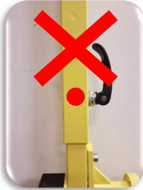
Controlegat volledig rood gekleurd en gesloten snelspanner, = niet klaar voor nieuwe slang
