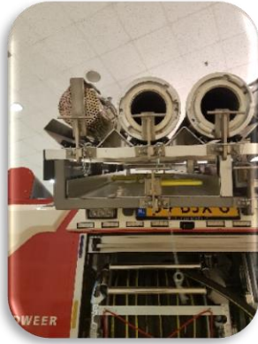
Slangenbundelapparaat in ladderrek
