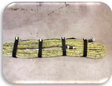
Geloste bundelbandjes, trek de Storz koppeling door naar andere zijde.
