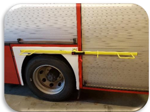
Slangenbundelapparaat geborgd in montagesteun, en gereed voor gebruik.
