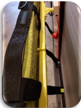
Plaats de bundelbandjes tussen de slang en het bundelapparaat.
