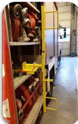
Slangenbundelapparaat geborgd in de voertuigsteun, en gereed voor gebruik.
