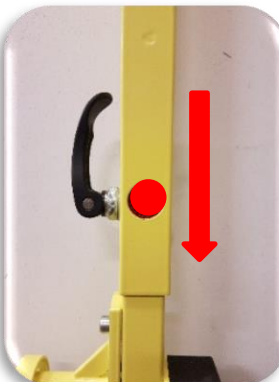
Controlelegat volledig rood gekleurd en gesloten snelspanner.
